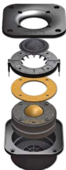
I tweeter Diva sono montati sul diffusore tramite un guscio di disaccoppiamento in gomma morbida, che rende virtualmente "flottante" il componente: si ottiene così una sensibile riduzione delle vibrazioni trasmesse dal mobile al tweeter stesso. La corretta escursione della cupola è controllata da una camera di risonanza radiale, provvista di due diversi tipi di assorbitore acustico, inseriti sotto la cupola ed all'interno dell'anello di ventilazione.
