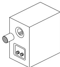
È possibile interfacciare il livello delle basse frequenze con le caratteristiche della stanza, semplicemente inserendo nel condotto reflex il tampone in dotazione a DIVA 255, 252 e 752.
